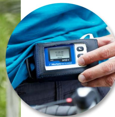
Progettato per soddisfare le esigenze di monitoraggio Holter più avanzate, il modello H12+ offre registrazioni a 12 derivazioni\* di qualità diagnostica utilizzando un cavo paziente a 10 fili.
